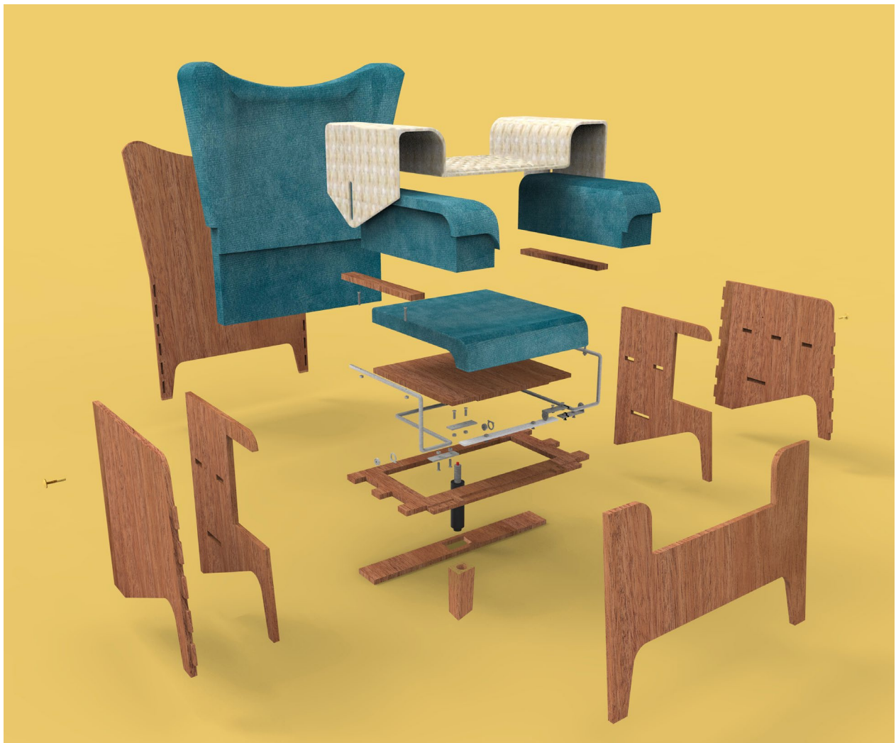
Detalle de vista explosiva donde se aprecian las piezas que componen el producto. Fuente: Elaboración propia.
