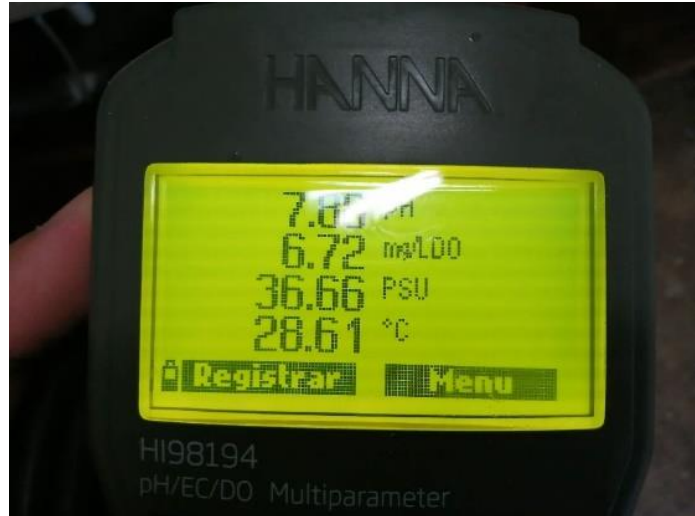
Fig. 9 Izquierda: foto del Espectrofotómetro HANNA iris utilizado para realizar los análisis de calidad de agua. Derecha: fotografía del Multiparámetro HANNA para el control de parámetros fisicoquímicos del agua.
