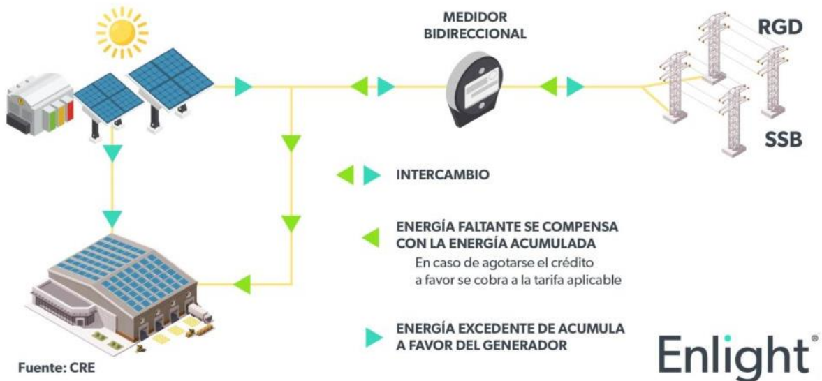
ILUSTRACIÓN 20. ESQUEMA NET METERING (CRE, ilustración por ENLIGHT,2020)
