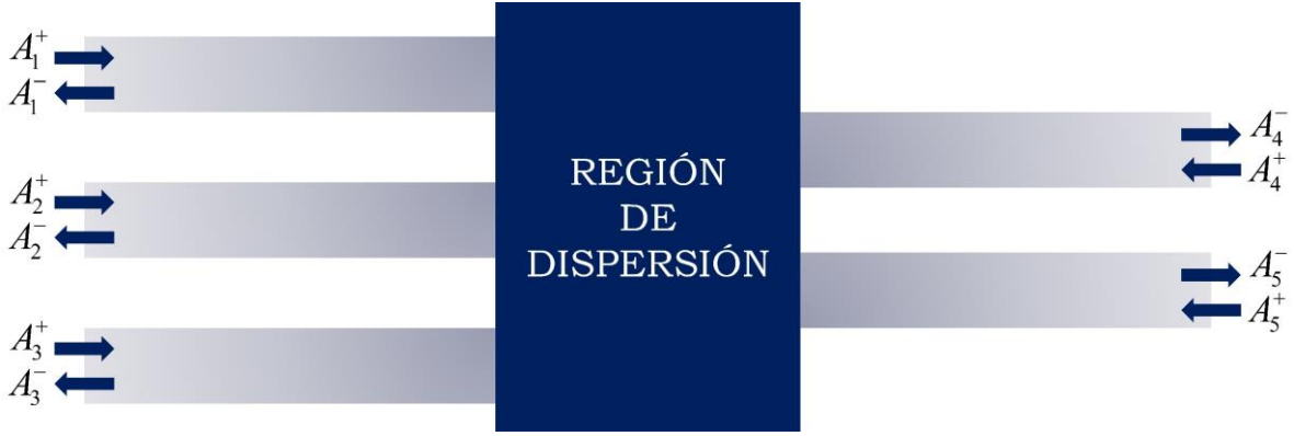
Figura 6: Representación de un sistema dispersivo con N = 5 canales, tres de ellos a la izquierda del sistema y dos a la derecha.
