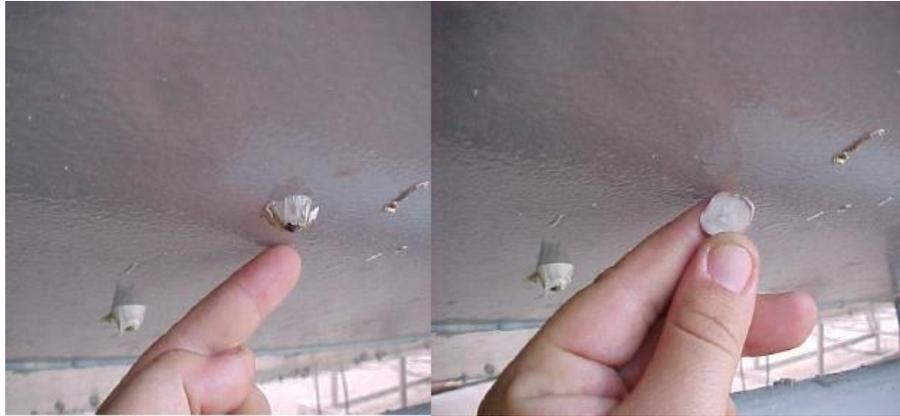
Fig. 10. Producto Interseleek 900 que es un recubrimiento sin biocidas con baja energía superficial que evita la fijación de organismos. (Rodríguez, 2019).
