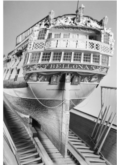
Fig. 9. Modelo a escala del casco del navío de 74 cañones HMS Bellona, revestido con cobre por debajo de la línea de flotación (Ciarlo, 2017).
