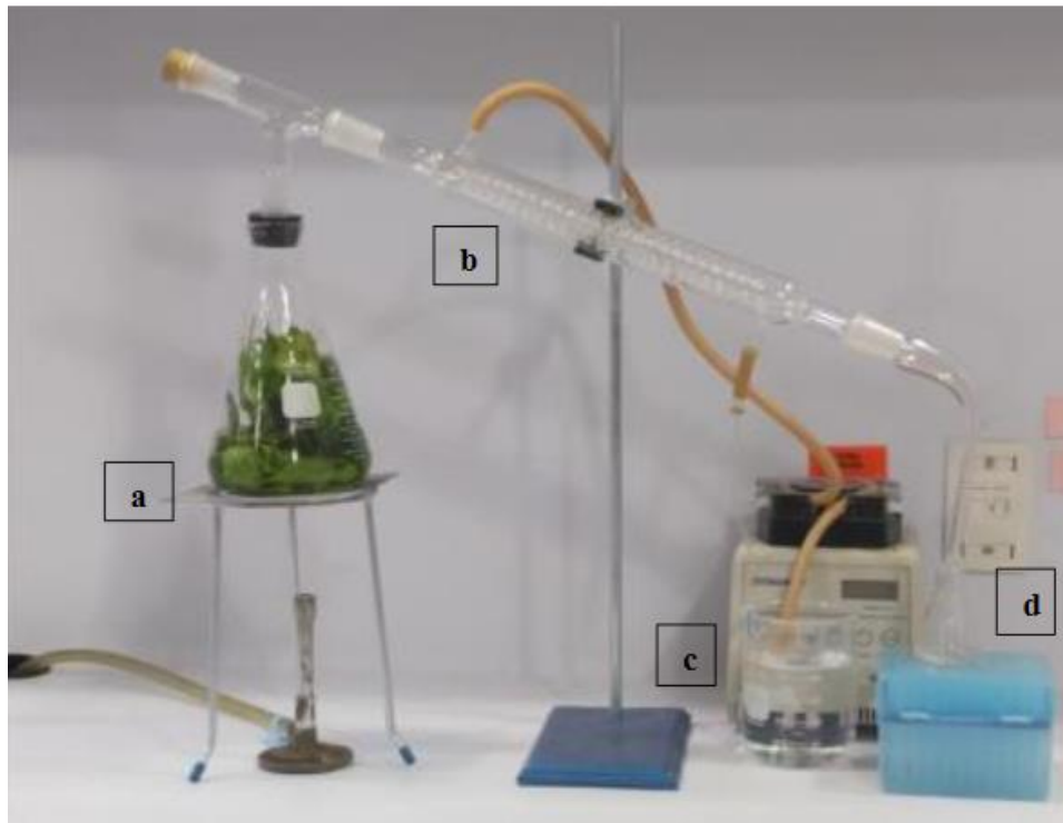
Fig. 9. Sistema de hidrodestilación. a) Matraz de Kitasato con hojas de Mentha spp y agua desionizada que se llevan a ebullición con un mechero de Bunsen. b) El vapor y el aceite es arrastrado a un condensador donde se enfría la mezcla. c) Agua de enfriamiento que circula por una bomba peristáltica. d) Se obtiene el aceite esencial de Mentha spp .
