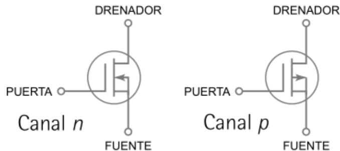
Figura 2.26 Símbolo eléctrico del MOSFET.
