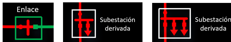
Figura 2.3. Seccionadores de enlaces y subestaciones generales
