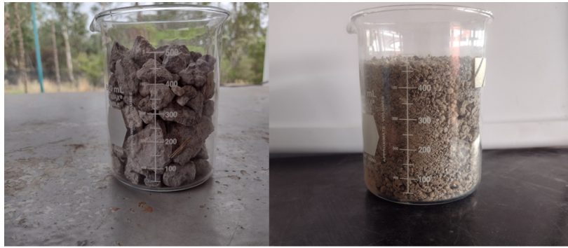
Figura 4.1: Tamaños de partícula del concreto usado en la construcción del tecnosuelo 1" (izquierda) y 3/16" (derecha).
