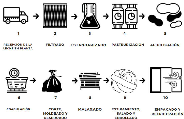
Ilustración 4: Proceso elaboración queso Oaxaca. Elaboración propia basado en Ramírez Nolla et. al.
