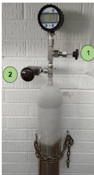
Figura 13 Celda utilizada en los experimentos de alta presión
