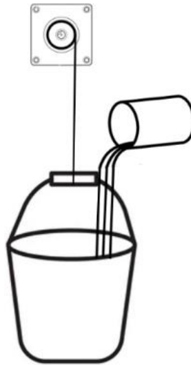
Figura 24. Prueba par de holding y prueba par de pull-in.
