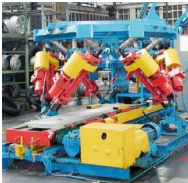
Figura 1. Plataforma Gough para prueba de neumáticos (Zhang, 2010).
