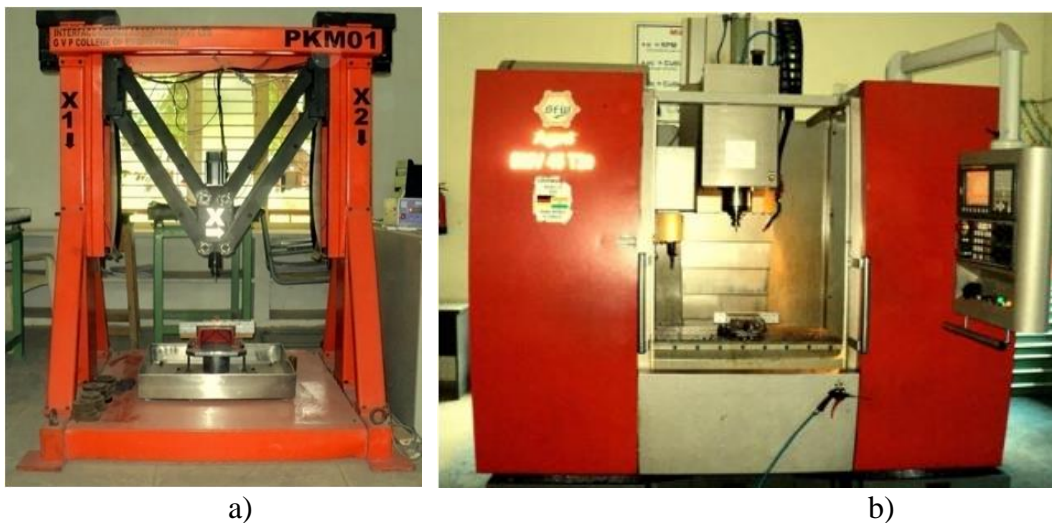
Figura 4. Experimento sobre capacidad de mecanizado. a) PKM de 2 GDL, b) CNC convencional vertical AGINI BMV 45T20 (Darvekar et al., 2021).
