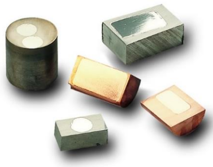
Figura 101 Muestras preparadas utilizando pulido electrolítico [83].
