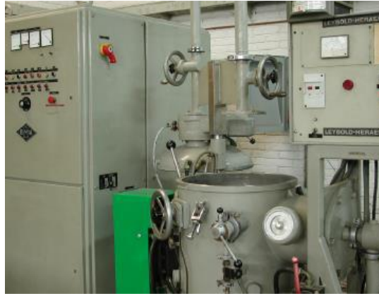
Figura 36 Horno de inducción del laboratorio IIM-UNAM [6].
