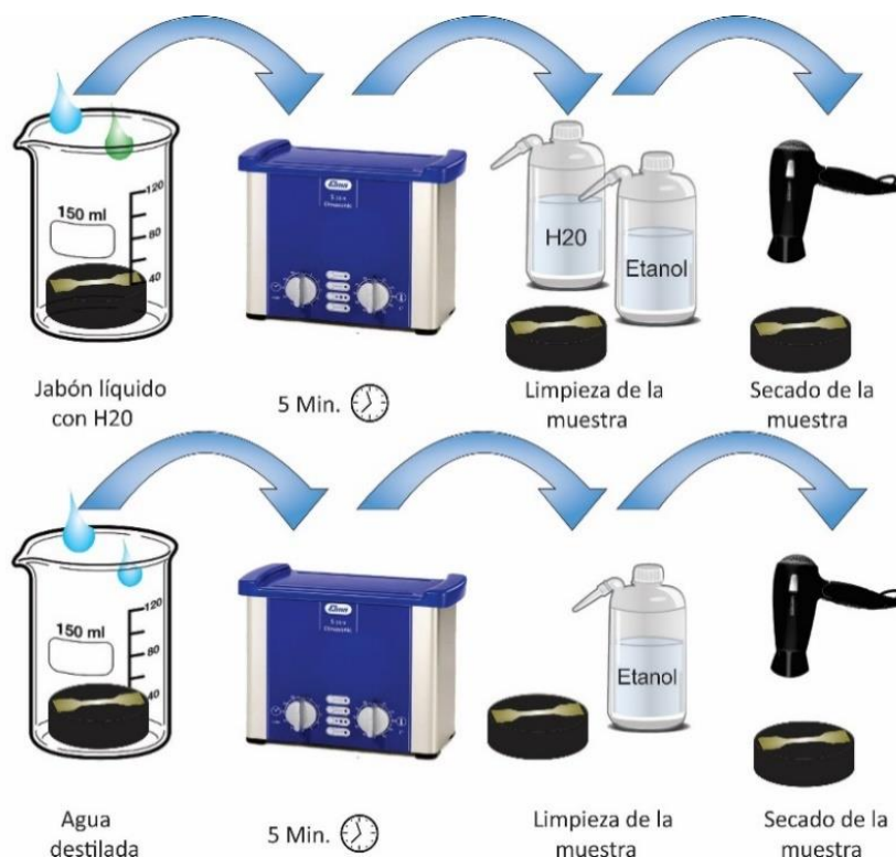
Figura 46 Pasos de limpieza de probetas pulidas.
