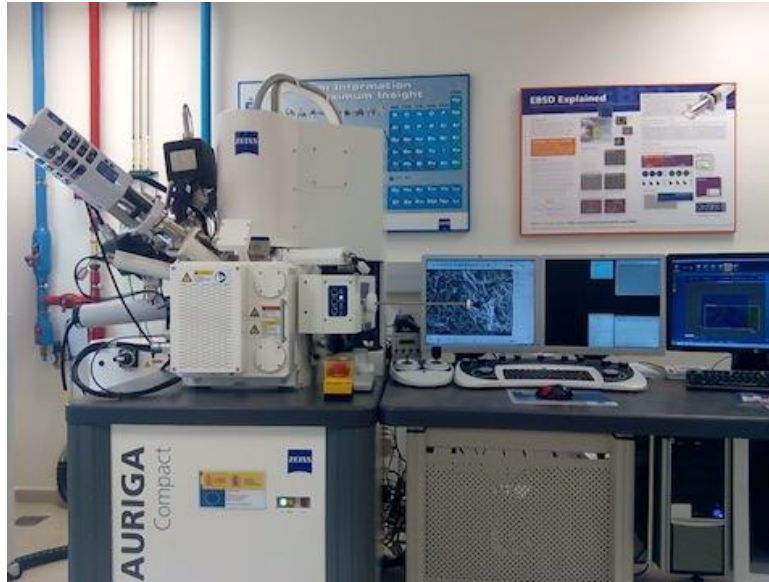
Figura 47 Microscopio Electrónico de Barrido de Emisión de Campo con Cañón de Iones Focalizados, Focused Ion Beam (FIB) Servicio de Microscopía Electrónica – UPV [58].
