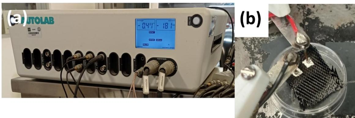
Figura 3.9 (a) Fotografía del potencióstato-galvanostato. (b) Conexión de electrodos hacia el potencióstato.
