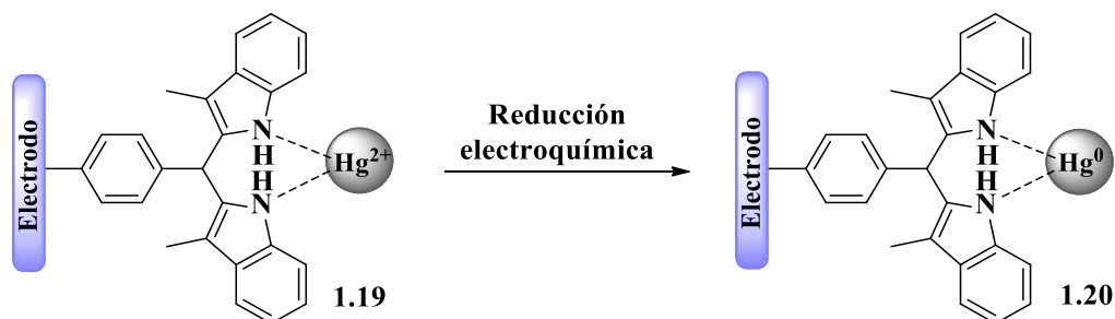
Esquema 1.6. 2,2'-BIM empleado como sensor electroquímico de mercurio.
