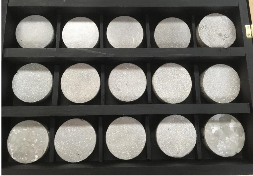
Figura 8. Patrones de comparación con diferentes tamaños de grano ASTM, utilizados para evaluar el tamaño de macrograno en las piezas experimentales.
