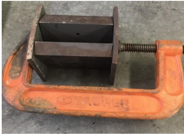
Figura 7. Molde permanente en forma de cuña
