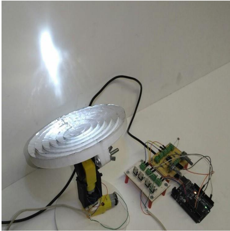
Figura 4.16 Superficie 3D programado y controlado con una tarjeta de desarrollo Arduino, como seguidor solar.
