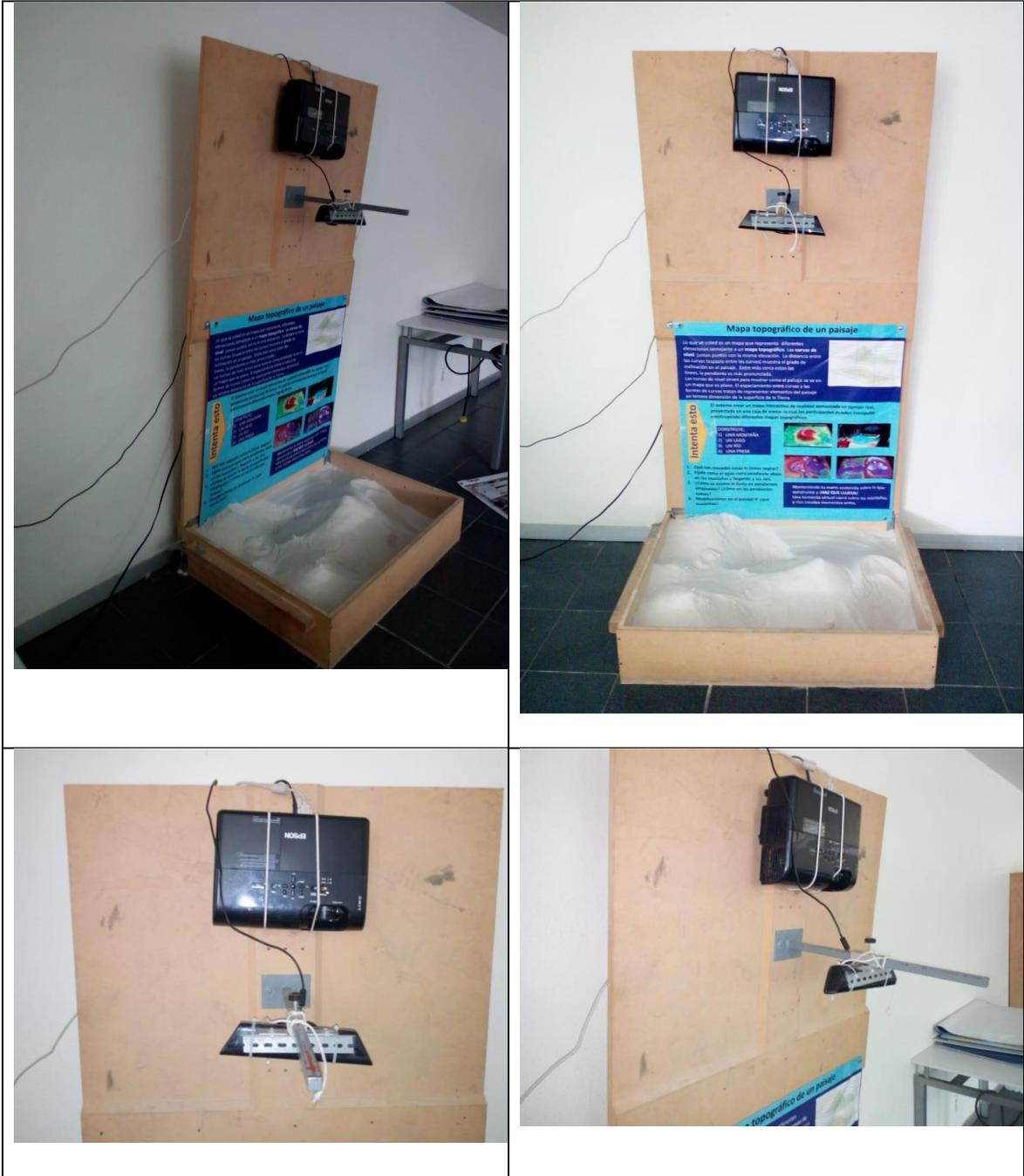
Figura II.2.3. Imágenes del sistema de la CARA construido por los autores que muestran la caja de arena con arena, el proyector y el Kinect. La computadora no se muestra en estas imágenes.
