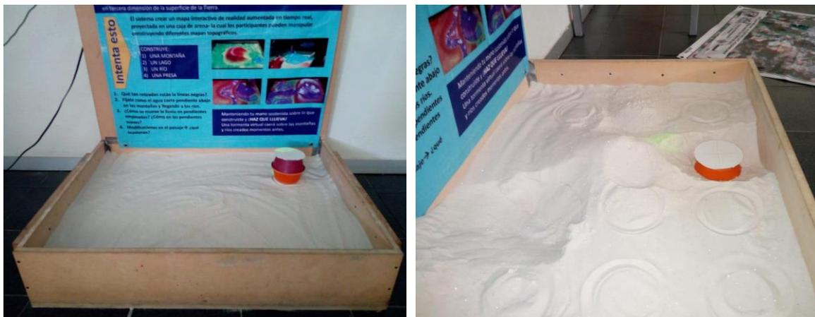
Figura II.2.16. Para incrementar la variación de la información capturada en los puntos de referencia: a) Caja de arena con arena nivelada y con el disco de calibración a una altura mayor de 5cm para tomar un punto de referencia más alto y b) Caja de arena con hoyos en la arena donde se coloca el disco de calibración para tomar un punto de referencia más bajo.
