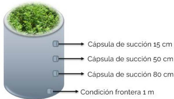
Figura 8. Ubicación aproximada de las profundidades de las cápsulas de succión en un lisímetro.
