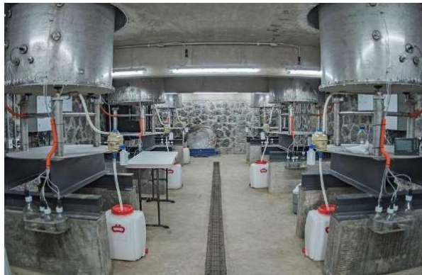
Figura 6. Estación de lisímetro, Instituto de Geología, UNAM (López, 2017)
