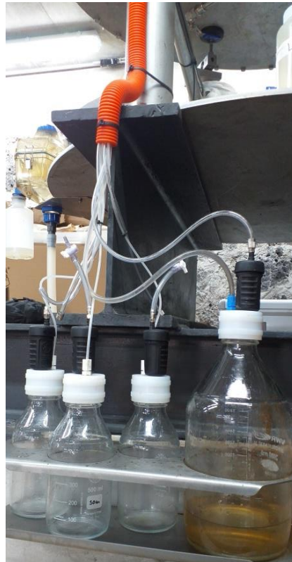
Fotografía 11 y 12. Frascos de recepción de cápsulas de succión y condición frontera.
