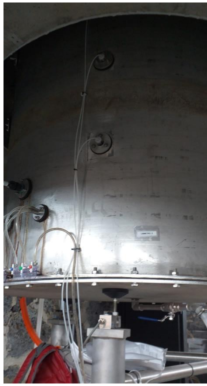
Fotografía 9 y 10. Sensores y ubicación de las cápsulas de succión
