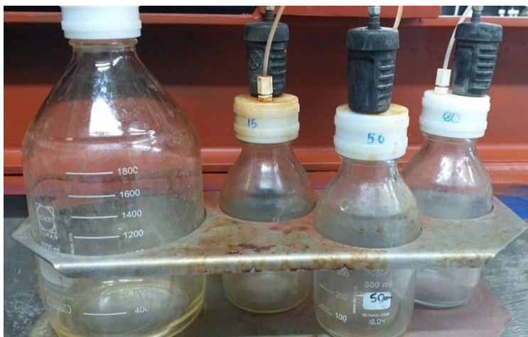
Fotografía 13. Frascos donde se recolecta el agua intersticial a las diferentes profundidades.
