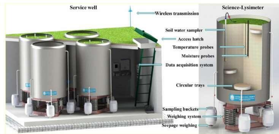
Figura 2. Diseño de un monolito de lisímetro de alta resolución (Zheng et al., 2020)
