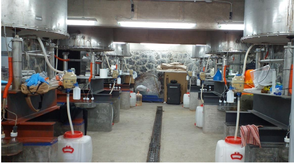
Fotografía 5. Lisímetros desde la parte interior
