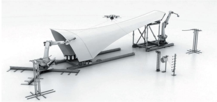
Fig. 53. Pabellón ICD/ ITKE 2016-17. Proceso de devanado multimáquina.
