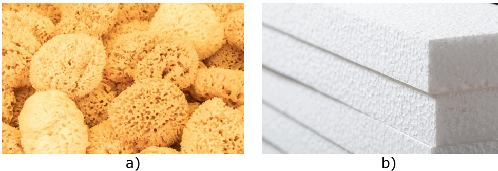
Figura 1.2: Tipos de esponjas poliméricas según su estructura porosa. a) Las esponjas de mar presentan una estructura abierta, la cual les permite alimentarse. b) Las esponjas de poliestireno expandido se fabrican con estructura cerrada, el EPS es un material ampliamente utilizado en la construcción.
