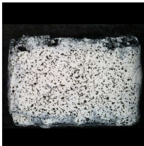
Figura 2.9: Técnica de correlación digital de imágenes. a) Programa desarrollado en LabVIEW para realizar la técnica DIC. b) Patrón de puntos de la primer esponja. c) Patrón de puntos de la segunda esponja.
