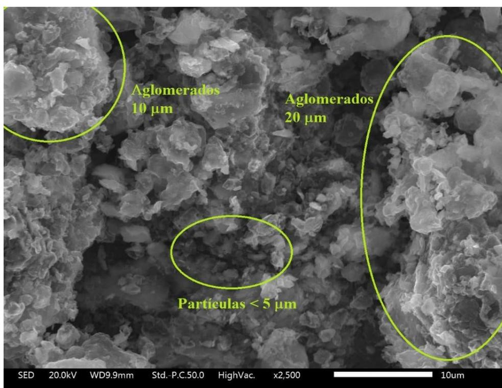
Figura 8.20: Imagen MEB de la mezcla  $3\text{LiBH}_4 + \text{FeCl}_2$  Cryomill 30 min 15 Hz molida.
