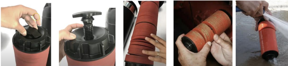
Figura 30 Ejemplo de los pasos a seguir para el mantenimiento del filtro de discos (UPV, 2017).
