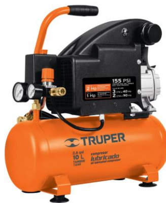
Figura 21 Compresor horizontal 10L, 1HP, marca TRUPER. Flujo @ 40 PSI (2.76 bar) 0.085 m 3 /min correspondiente a un flujo másico de aire de 0.102 kg/min (TRUPER, 2022).
