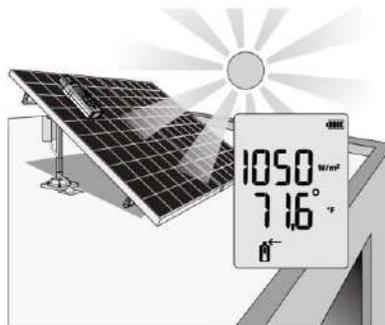
Figura 20 Colocación del medidor Fluke [34].
