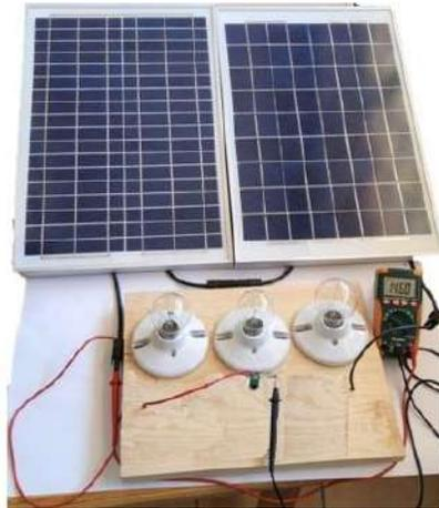
*Figura 55 Sistema de adquisición de corriente. Fuente propia.*
