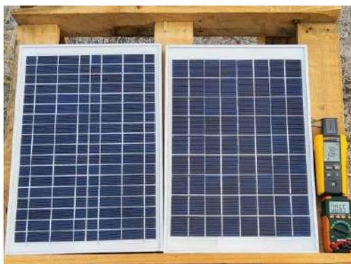
Figura 57 Sistema de adquisición de irradiancia, temperatura del panel y corriente. Fuente propia.
