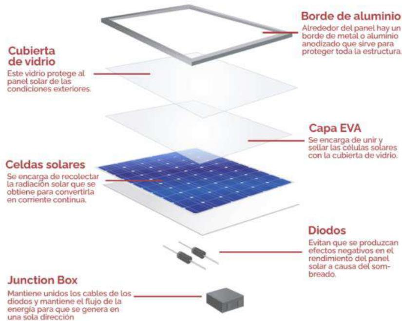
Figura 8 Estructura de un sistema fotovoltaico [21].
