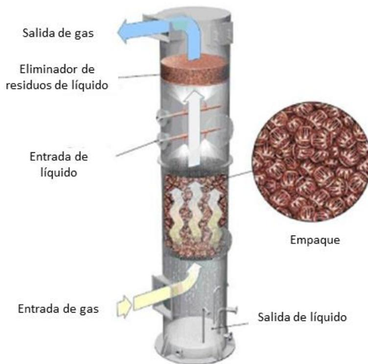
Figura 1. Diseño típico de una columna de absorción empacada (Pérez Sánchez, Pérez Sánchez, & Segura Silva, 2016) Reproducido bajo permiso de Nexa revista científica
