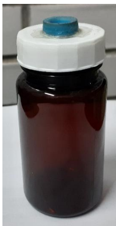
Figura 1. Muestra del dispositivo para medir la respiración edáfica
