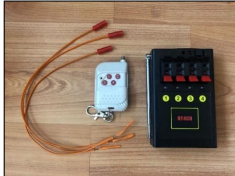
Figura 24. Sistema de ignición a distancia por radiofrecuencia.
