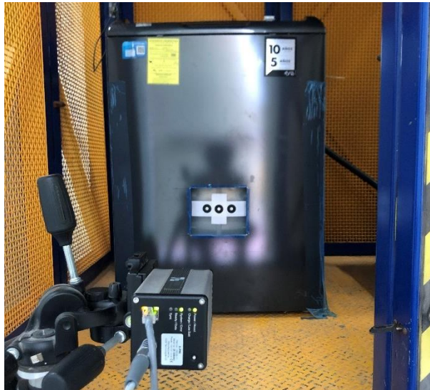
Figura 32. Corte frontal en lavadora para rastreo con cámara rápida.
