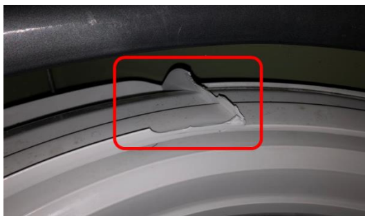
Figura 45. Daño en unidad provocado por falla súbita en corrida de validación.
