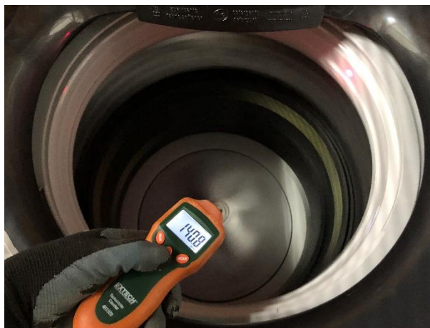
Figura 31. Zona de medición para tacómetro.
