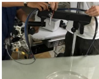
Figura 41. Instrumentación para la toma de espectros por fluorescencia de rayos X en probetas. Fotografía: Nathael Cano Baca
