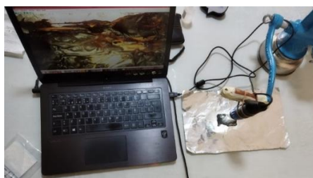
Figura 40. Instrumentación para la toma de imágenes por microscopía óptica en probetas de hules.
