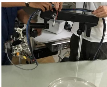
Figura 45. Instrumentación para la toma de espectros por fluorescencia de rayos X en objetos de patrimonio cultural. Fotografía: Nathael Cano Baca
