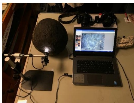
Figura 44. Instrumentación para la toma de imágenes por microscopía óptica en objetos de patrimonio cultural. Fotografía: Nathael Cano Baca
