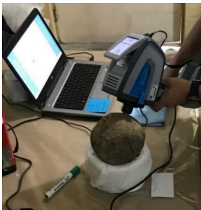
Figura 46. Instrumentación para la toma de espectros por espectroscopia infrarroja en objetos de patrimonio cultural. Fotografía: Nathael Cano Baca
