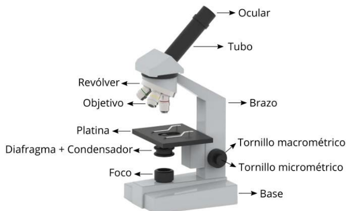
Figura 24. Estructura de un microscopio óptico Recuperada de la URL: https://www.mundomicroscopio.com/wp-content/uploads/2017/02/partes-del-microscopio.jpg (16/02/2021)
