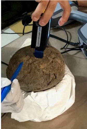
Figura 47. Instrumentación para la toma de espectros por espectroscopia Raman en objetos de patrimonio cultural. Fotografía: Nathael Cano Baca
