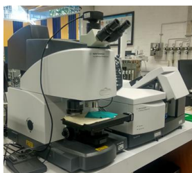
Figura 42. Instrumentación para la toma de espectros por espectroscopía infrarroja en probetas de hule.
