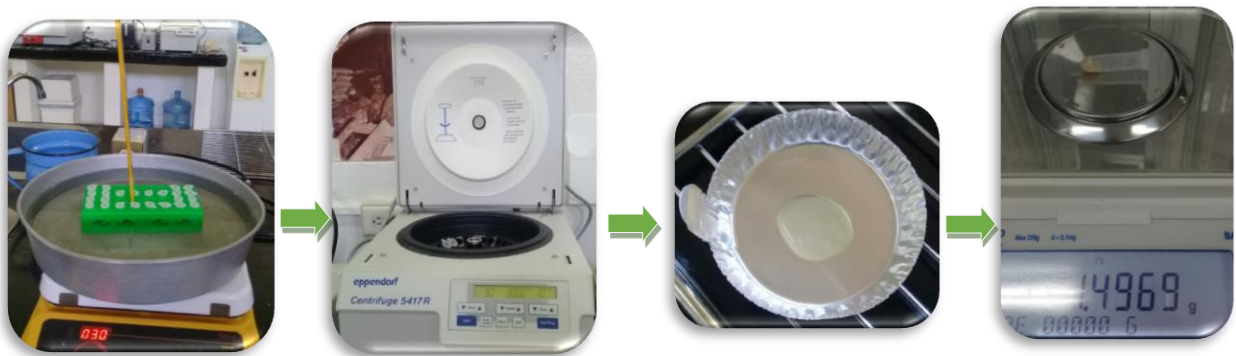
Figura 2. 3 Proceso de determinación de índice de absorción
