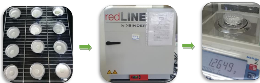
Figura 2. 4 Proceso de determinación de índice de solubilidad en agua.
