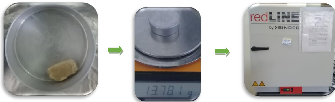
Figura 2. 6 Proceso de determinación de humedad de la masa.
