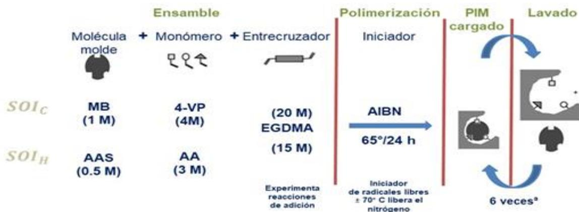
**Figura 9.-Reacción de polimerización para el diseño de MIP's imitadores del olor de cocaína y heroína. Adaptado [116, 131]**
