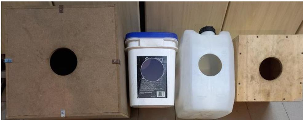
**Figura 8.-Cajas de condicionamiento odorífero (CCO) manufacturadas en MDF, madera y plástico rígido, con un orificio en una cara de 10 cm de diámetro.**
