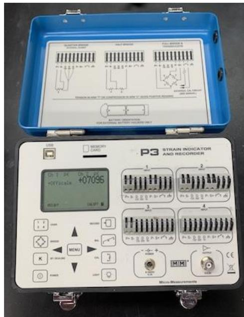
Figura 34. Equipo de adquisición de datos P3 [13].
