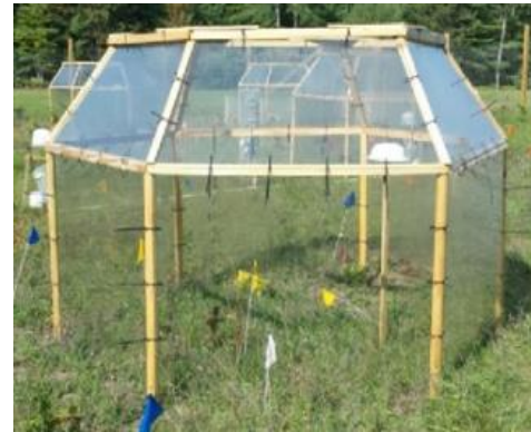
figura 8 Dos propuestas de cámaras abiertas. I-Cámara abierta de Heagle et al., (1973) con sistema de ventilación y filtración de aire. D-OTC “pasiva” de Welshofer et al., (2018), la cual actúa como un invernadero en miniatura para monitorear humedad y temperatura sin generar corrientes de aire ni simulación de contaminantes (Marion et al., 1997).
