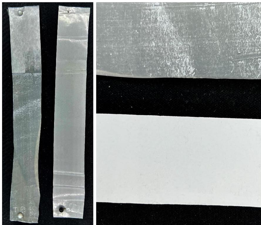
Figura 5 Probeta ensayada ST50TPS - Papel
