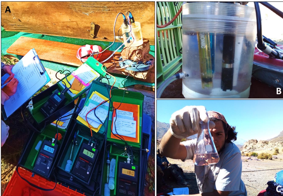
Fig. 38. Fotografías del trabajo de medición de parámetros fisicoquímicos del agua subterránea en campo (enero, 2021). A) Equipos utilizados. B) Celda de aislamiento y sensores. C) Prueba de alcalinidad.
