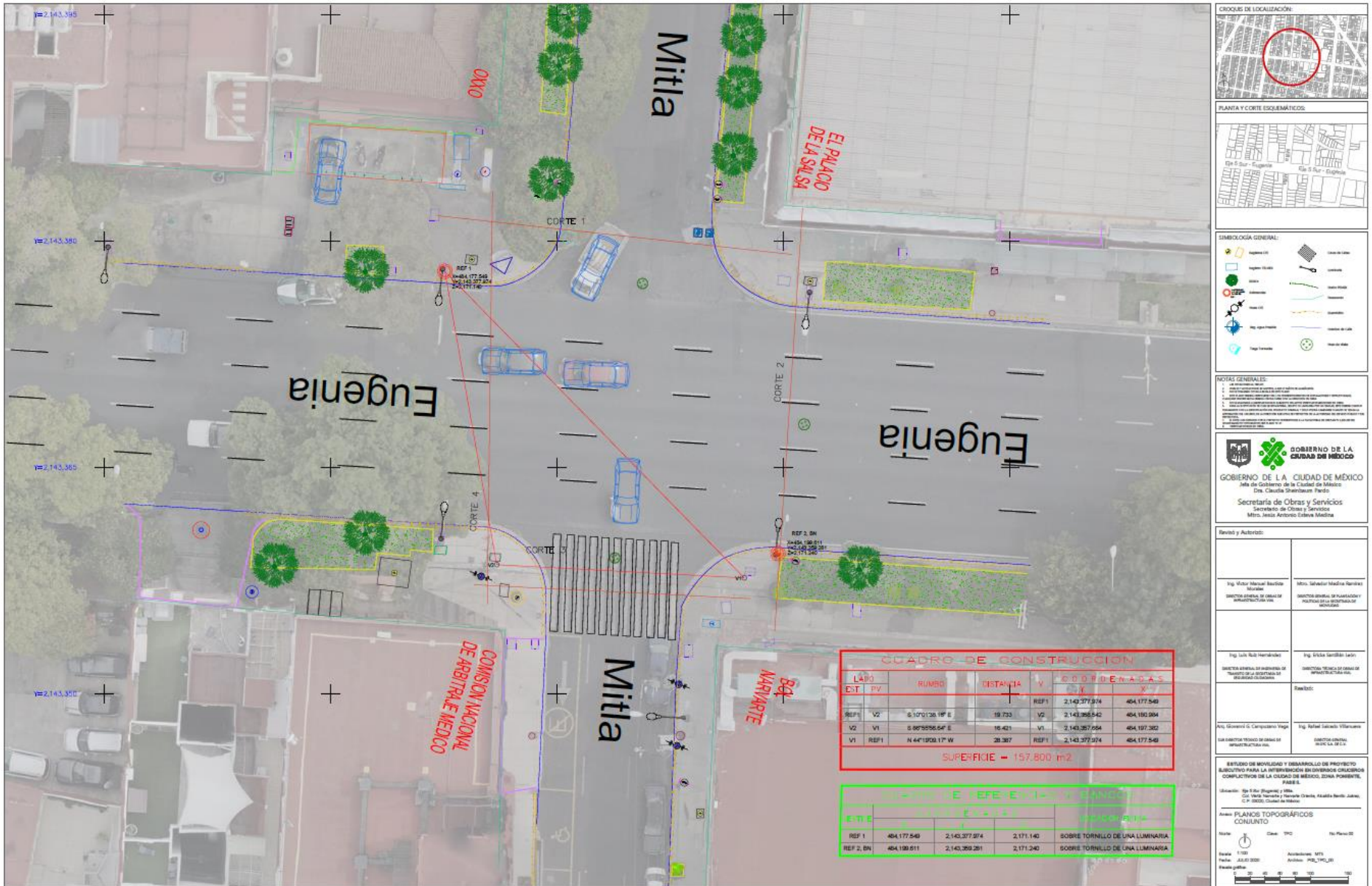
Plano 5 Levantamiento topográfico con cuadro de construcción y poligonal cerrada - Fuente: IN-SYC Move.
