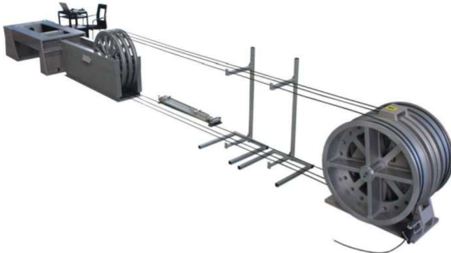
Figura 4.3 Máquina utilizada para prueba de resistencia a la tensión bajo la norma internacional ECI [5]
