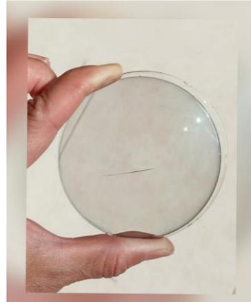
Figura 12. a) Mica fotocromática expuesta al sol. b) Misma mica fotocromática con una mica con protección UV encima. Imágenes propias.
