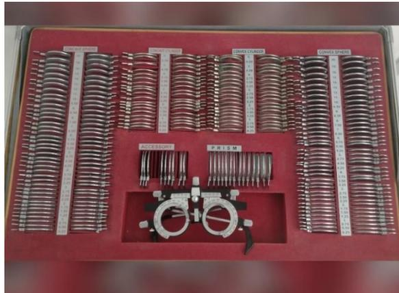
Figura 16. Caja de pruebas para evaluación visual, contiene lentes positivas y negativas de hasta 20 dioptrías, así como lentes cilíndricas de hasta 6 dioptrías. Imagen propia.
