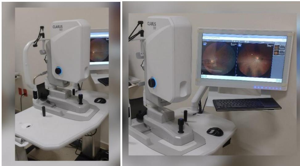
Figura 31. Cámara de fondo de ojo, es un microscopio de baja potencia con una cámara adjunta que se utiliza para evaluar el polo posterior del ojo y detectar oportunamente diversas patologías oculares. Imágenes propias.
