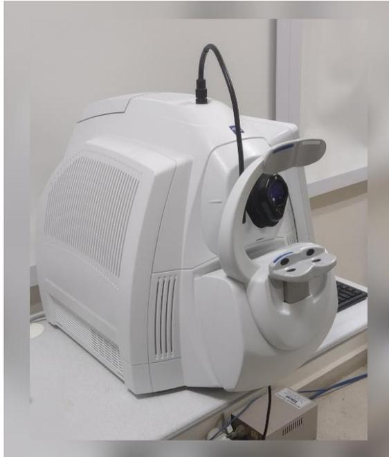
**Figura 32.** Tomógrafo de coherencia óptica (OCT). La tomografía de coherencia óptica es una prueba que se lleva a cabo para evaluar el segmento anterior y posterior de ojo, mediante imágenes que proporcionan “cortes” de resolución micrométrica de la estructura a evaluar. Imagen propia.
