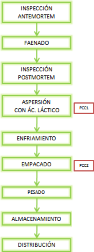
Figura 10. Diagrama de proceso para la obtención de la canal de conejo para distribución.
