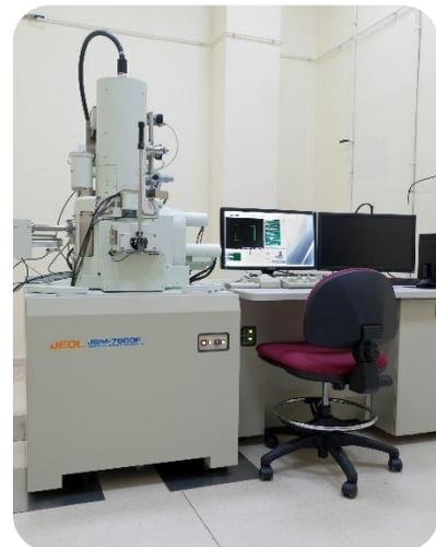
Figura 27.0 Instrumento FESEM marca JEOL modelo JSM-7600F
