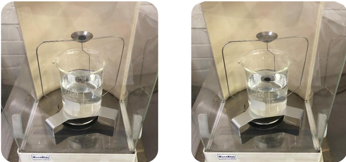
Figura 29.0 Medición de masa de las pastillas en aire (izquierda) y agua (derecha) para la aplicación del método de Arquímedes.
