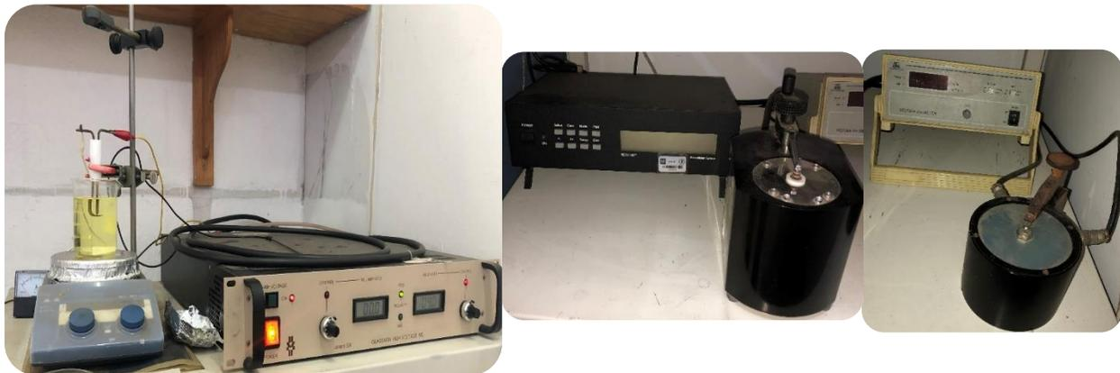
Figura 34.0 Sistema para polarizar las pastillas, se sumergen en aceite para evitar arcos eléctricos (izquierda), PiezoMeter System PIEZOTEST (centro) y APC International YE2730A  $d_{33}$  METER (derecha)
