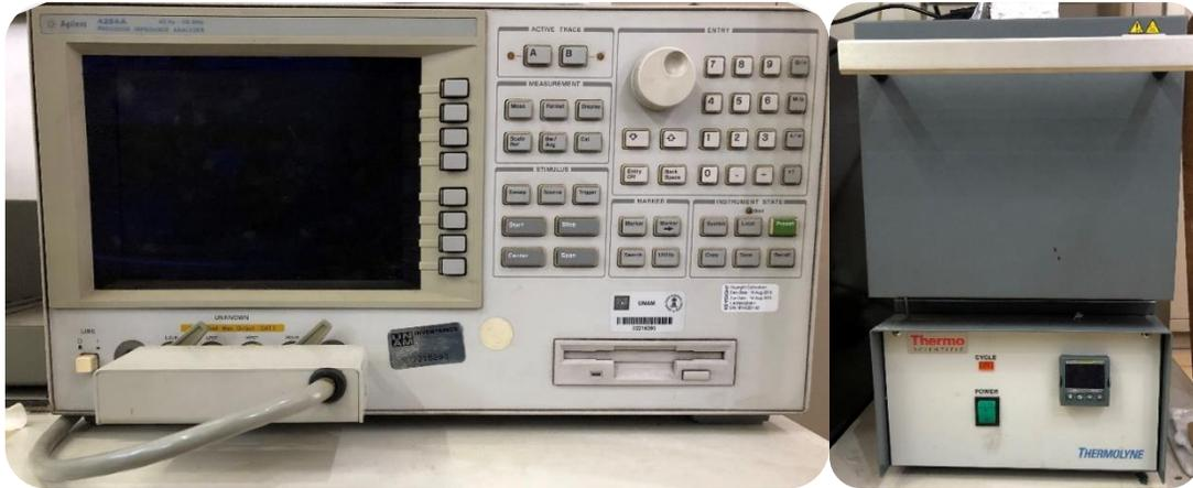
Figura 33.0 Analizador de impedancias de precisión Agilent 4294-A (izquierda) y mufla de calentamiento controlado THERMOLYNE (derecha)
