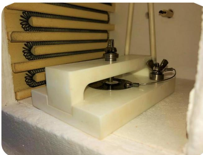
Figura 32.0 Sistema para medir ciclos de histéresis, al centro se observa la pastilla electroada.
