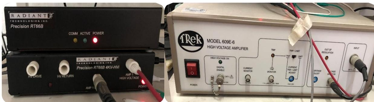
Figura 31.0 Radiant Precision RT66B (izquierda) y amplificador de alto voltaje MODEL 609E-6 (derecha).
