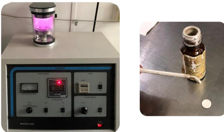
Figura 30.0 Sistema de depósito por plasma Sputtering (izquierda) y colocación de electrodo de plata (derecha).
