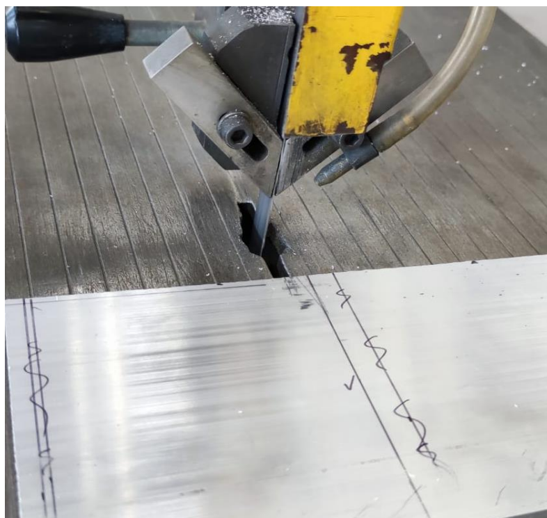
Figura 33. Maquinado de 24 probetas en total para recubrir y realizar ensayos de adhesión, dureza, abrasión, corrosión acelerada, inmersión salina, EIS. Proceso de corte con sierra cinta.
