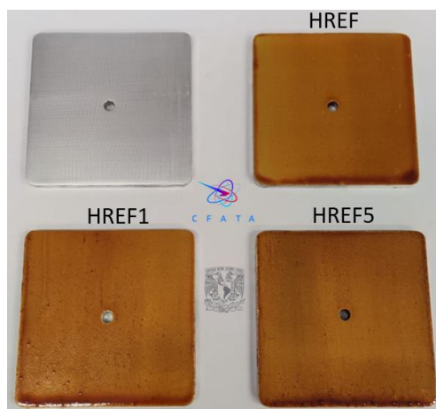
Figura 38. Probetas 10 cm x 10 cm recubiertas con los diferentes híbridos
