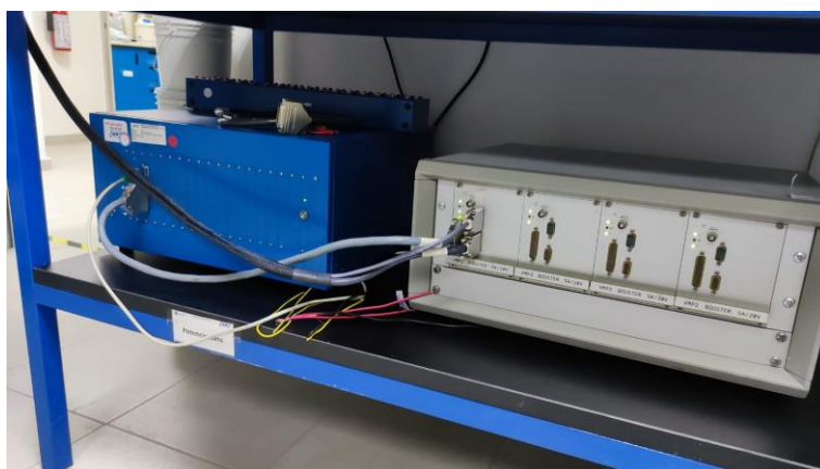
Figura 47. Potenciostato y Booster utilizados
