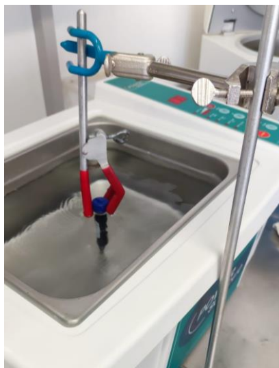
Figura 25. Baño ultrasónico para exfoliar y laminar el óxido de grafeno
