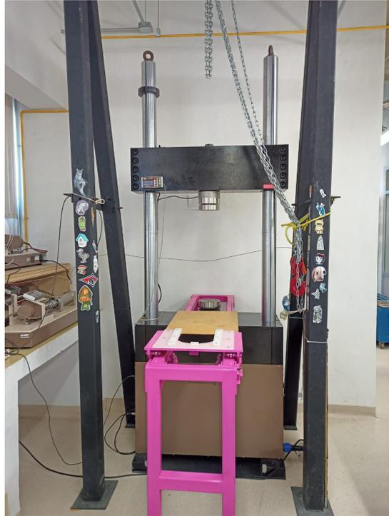
Figura 4.1: Prensa de carga de rigidez virtual infinita GDS ubicada en La Unidad de Petrofísica.
