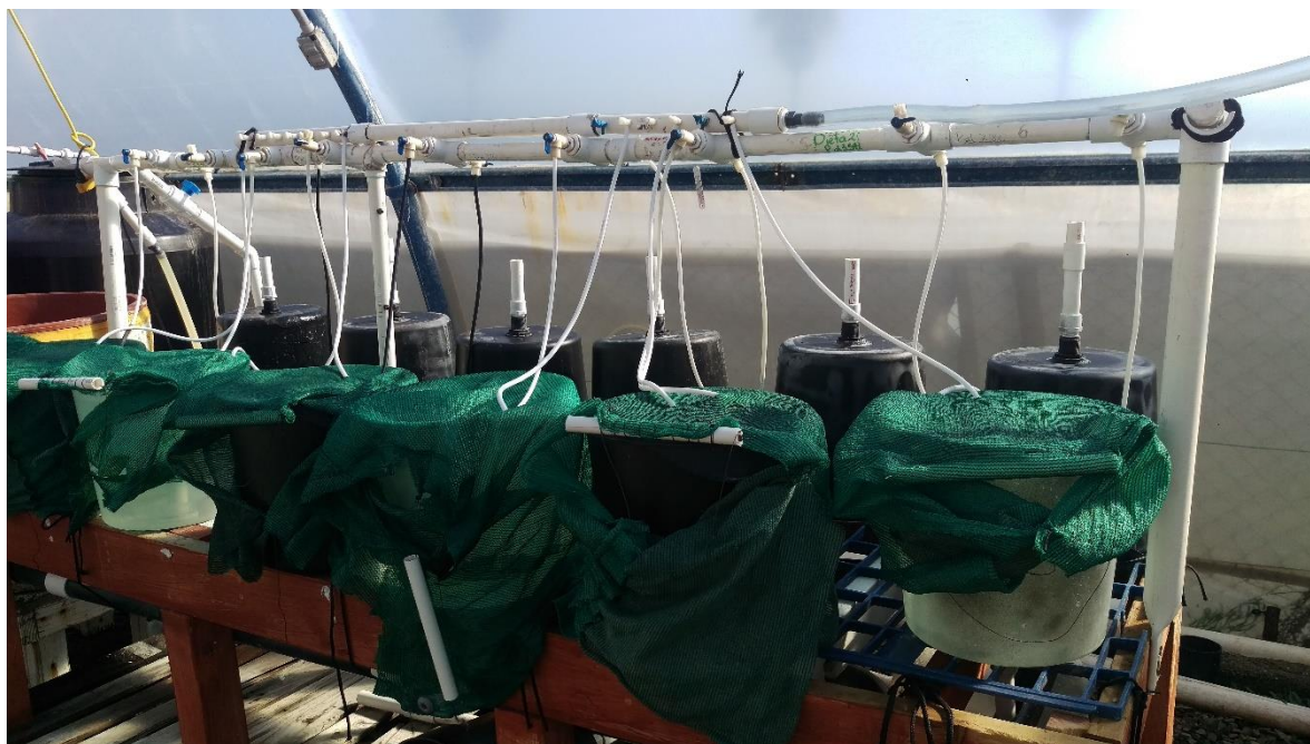
Figura 6.3. Sistema de recirculación de 6 cubetas de 20 L con camisa de malla y pesas para evitar el salto de organismos entre las cubetas.
