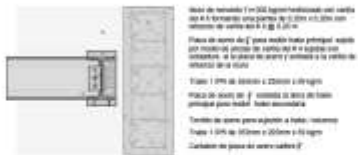
4. E.L. ANEXO DE CONCRETO DE PARED PERIMÉTRICA Y PLATA DE ACERO
