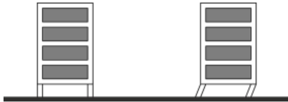
Gráfico 1 – [Comportamiento de Planta Libre en un Sismo]. Nieves, L. (18 de febrero de 2021)
