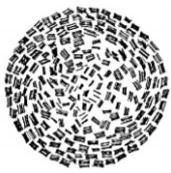
Figura 2.32 Modelo de negro de humo propuesto por Heckman y Hardling en 1966 [75].
