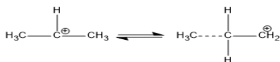
Figura 2.11 Reacción de isomerización de la carga [31].
