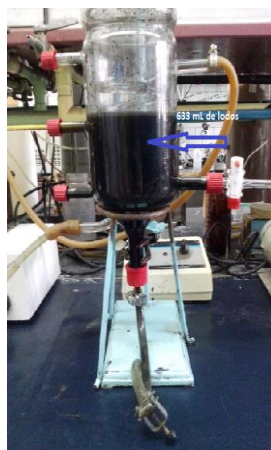
Fig. 1.2. RALLFA a escala de laboratorio (Poblete-Mier, 2015)
