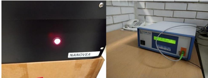
Figura 46. Perfilómetro Nanovea® (izquierda) y el sensor de cromática confocal (derecha). Si la luz del perfilómetro esta encendida, significa que el equipo esta apagado.
