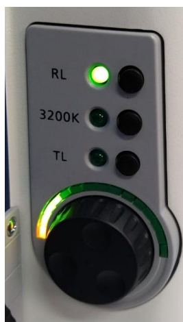
Figura 30. Controlador de intensidad de luz.
