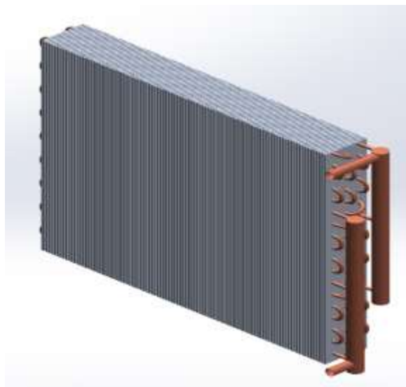
Imagen 118 Intercambiador de tubos y aletas sin cubierta (elaboración propia)
