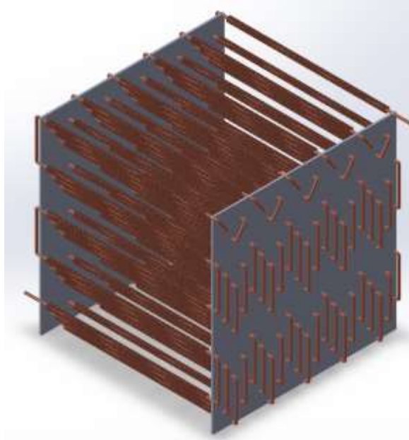
Imagen 105 Intercambiador geotérmico (Flores, 2021)
