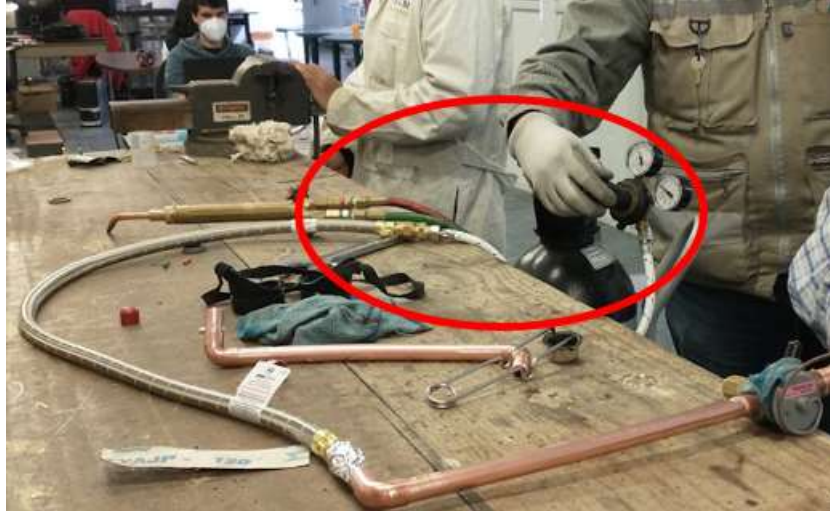
Imagen 151 Soldadura con oxiacetileno con ambiente de nitrógeno (elaboración propia)
