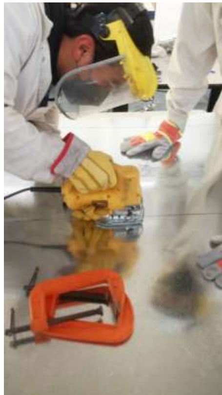
Imagen 141 Corte por medio de sierra caladora para las láminas de acero galvanizado calibre 24
