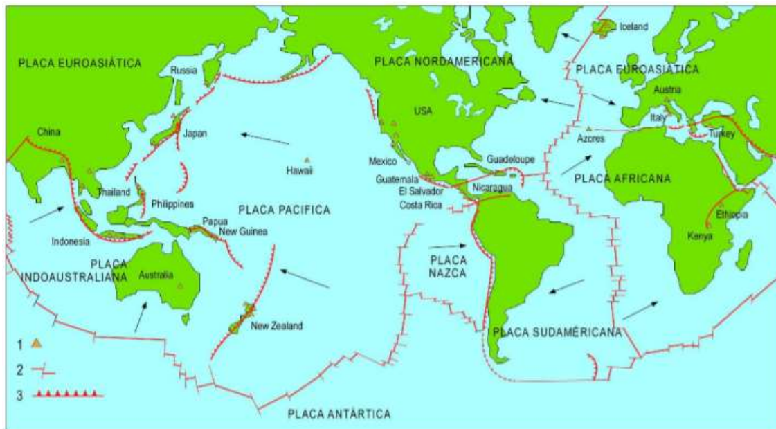
Imagen 46 Placas litosféricas, dorsales y fosas oceánicas, zonas de subducción y campos geotérmicos (Fanelli, 2004)
