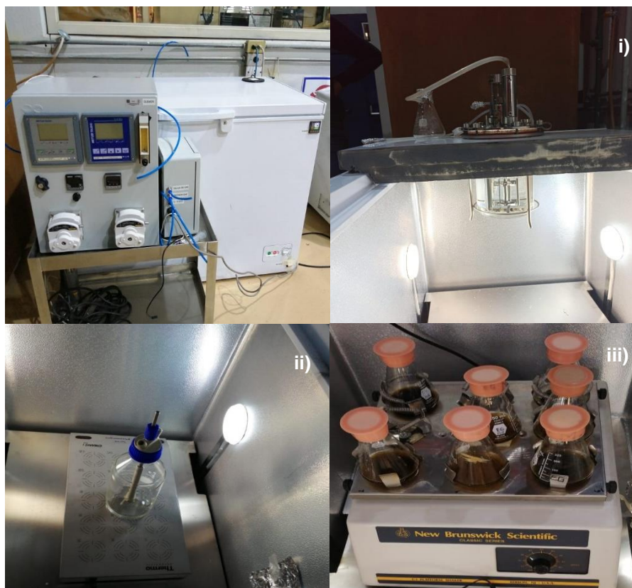
Figura 7.1. Imágenes del equipo diseñado para la realización de los cultivos en condiciones de mixotrofia de este trabajo: i) sistema biorreactor 3 L, ii) sistema biorreactor 1 L, iii) sistema agitación orbital matraces.
