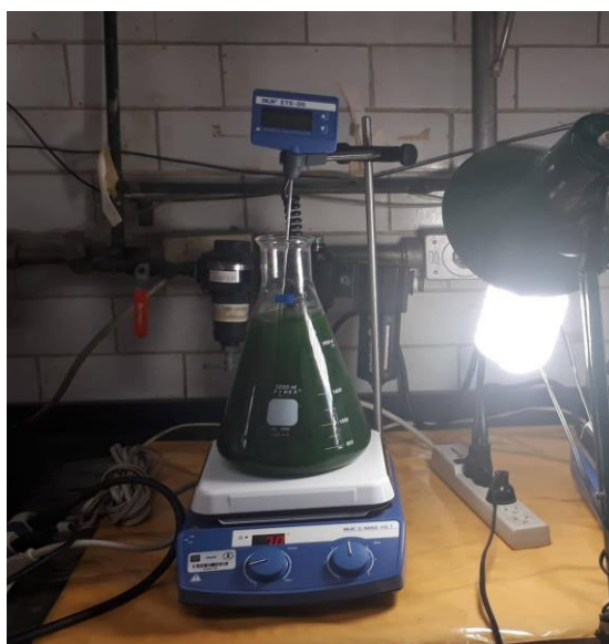
Figura 7. Reactor de 2 L a las condiciones de 36°C y con pH controlado de 8.5.
