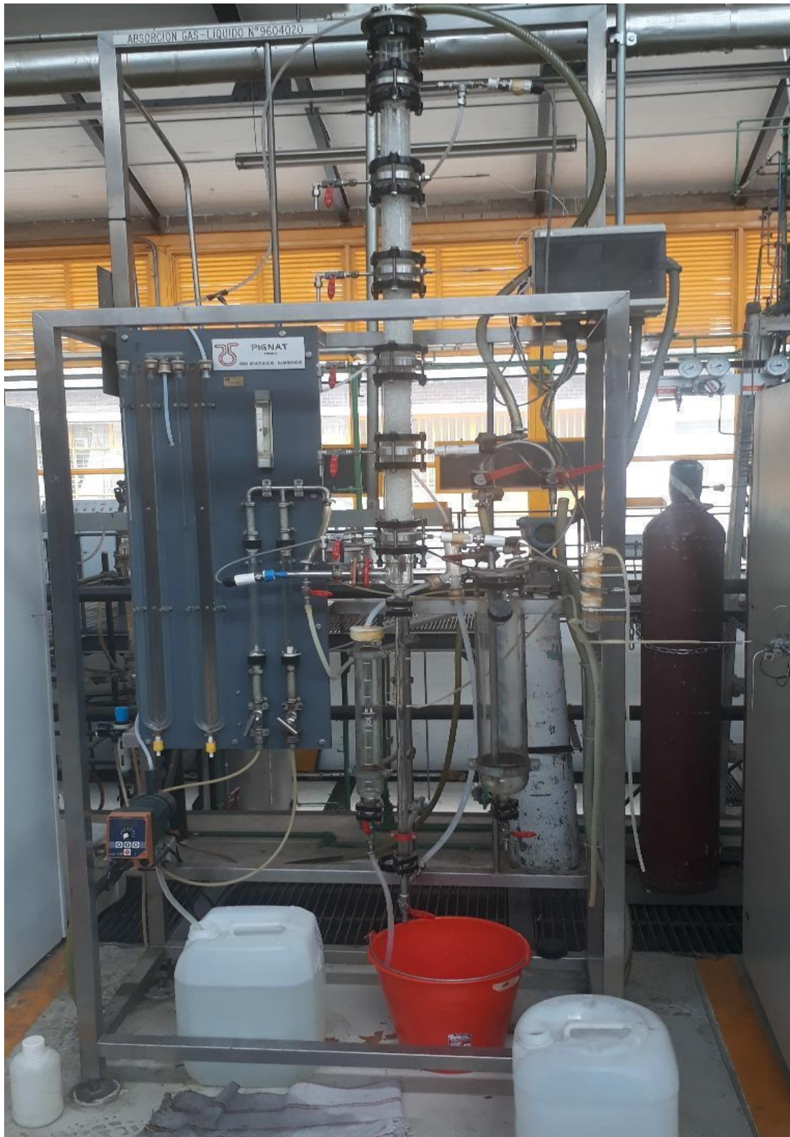
figura 14. Proceso de absorción de \text{CO}_2 en medio mineral gastado de cultivo de Arthrospira maxima realizada en una torre de absorción marca Pignat.
