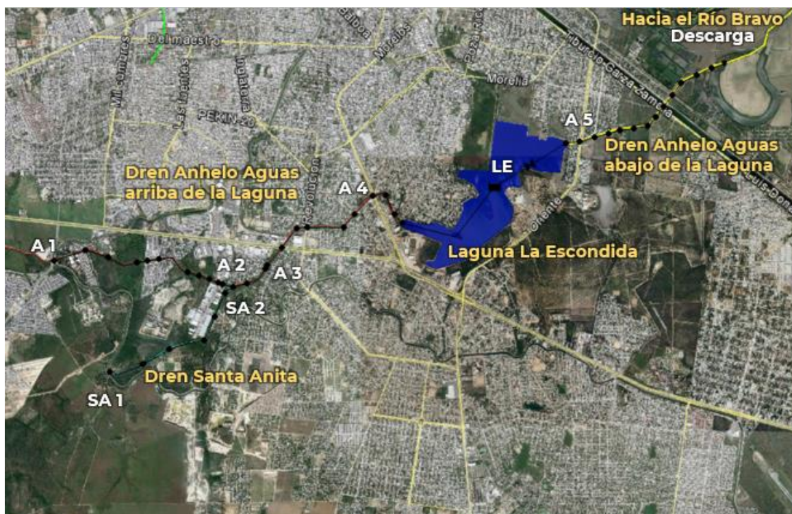
Figura 15 Laguna La Escondida, Dren Santa Anita y Dren Anhele aguas arriba y abajo de la Laguna La Escondida y determinación de puntos de control
